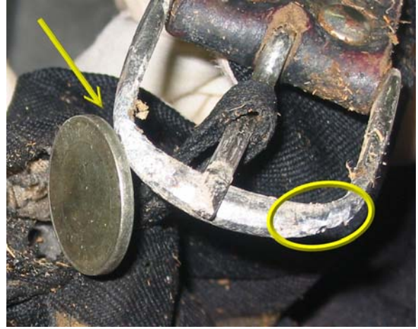
Şekil 4. Kemer tokasında erime ve muknatislanma
